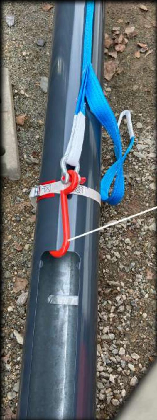
*Le Crochet en S et la Manille vous permette de soulever le candélabre par la trappe*
